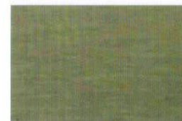
Каменная панель Защитное покрытие с применением каменной крошки, закрепляемой клеем EVA, используемое после нанесения пленки и перед настилкой линолеума. Материал: каменная крошка + клей EVA Размеры: 100см × 100см × 0,2см
