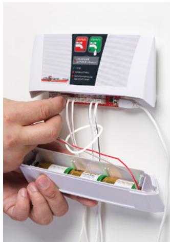
Подключенные провода кранов и датчиков затянуть специальным хомутом, который имеется в комплекте.
