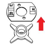
Снимите контактную пластину с доньшка, подняв ее вверх
