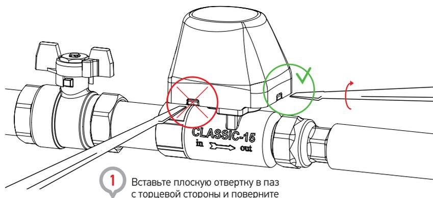
1 Вставьте плоскую отвертку в паз с торцевой стороны и поверните
