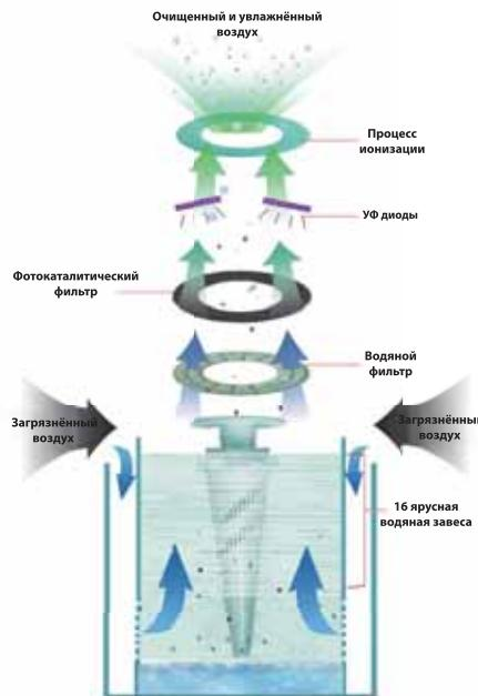
ярусную водяную завесу, через которую прокачивается воздух, где происходит процесс промывки и насыщения воздуха влажностью, одновременная фильтрация и деструкция вредных примесей, отделение более тяжелых загрязняющих элементов, которые вместе с излишней водой, опускаются на нижний уровень очистки, или оседают в поддоне. Это позволяет эффективно произвести очистку воздуха («мойку воздуха») в помещении, удалить мельчайшие частицы пыли, аллергены и ликвидировать посторонние нестойкие запахи.
