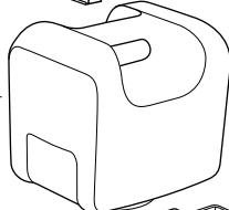
Bouchon du réservoir d'eau
